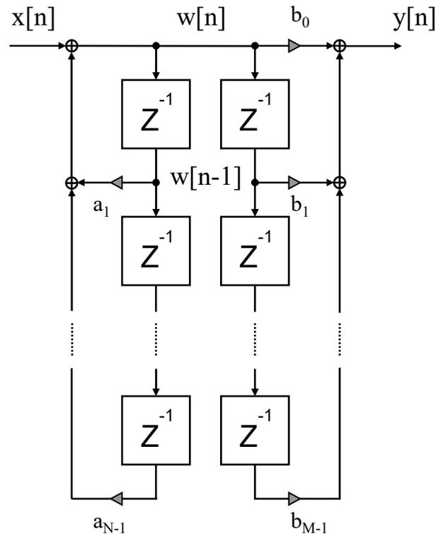
esta estrutura corresponde à *estrutura direta do tipo II de realização de um sistema IIR* e facilmente se verifica que resulta simplesmente de trocar a ordem dos subsistemas em série na *estrutura direta do tipo I*, o que, dada a propriedade de comutatividade da representação em  $Z$ , não modifica o sistema implementado.
